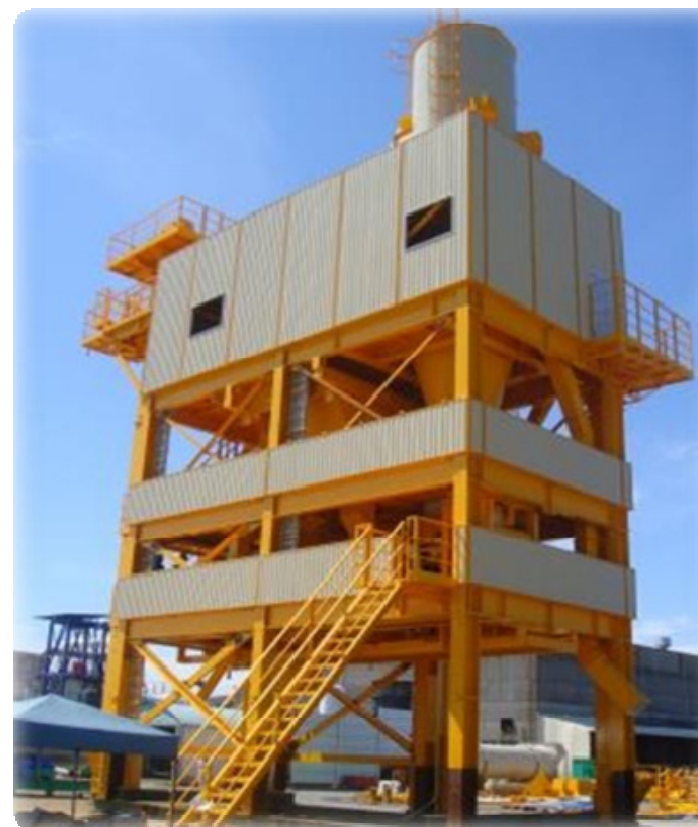
【アスファルトプラント】…写真は本社工場内仮組時のもの
