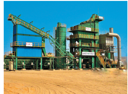
アルジェリアで稼働中の日工(上海)製 アスファルトプラント「NBD-320」
