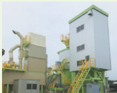
石膏系固化工材製造設備 石膏粉を乾燥し半水石膏を製造。セメントや石灰とブレンドし固化工材を製造する設備です。
