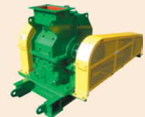
ハンマークラッシャー ロストルサイズにより粒度調整ができ、1回の破碎で希望粒度へ
