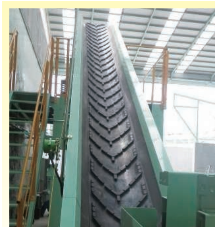
Y型栈モジュールコンベヤ (MC60TP2-8.1MYU)
