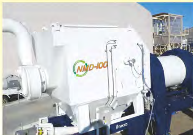
廃石膏加熱リサイクルシステム
