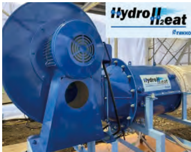
水素燃料を利用した熱風式直火型ジェットヒーター
