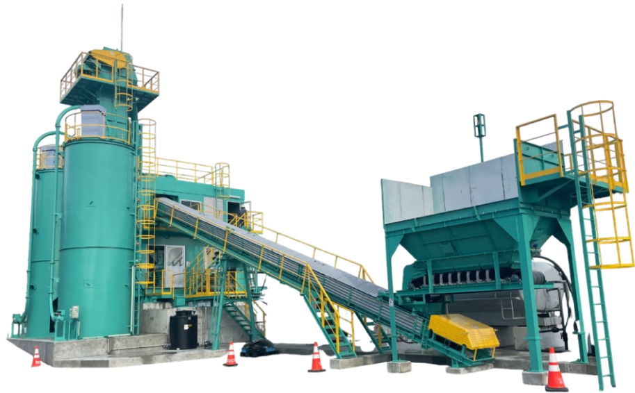
流動化処理土プラント
