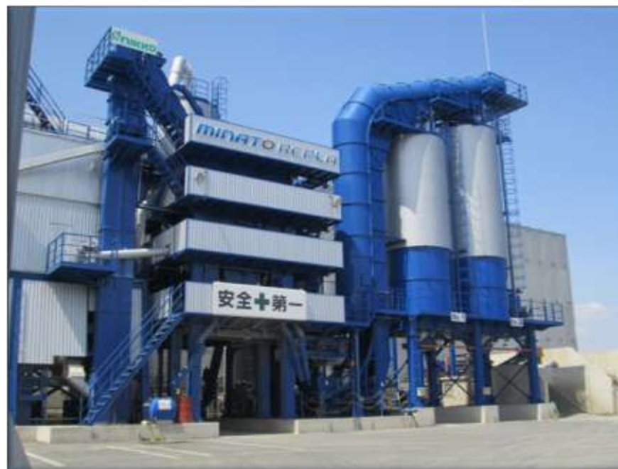
ガスバーナーを採用した都市型アスファルトプラント(ABD1600)/大阪府
