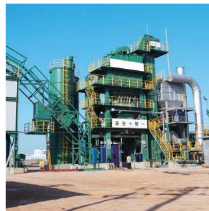
山東省青島市で稼働中の日工(上海)製 アスファルトプラント NBD240ABZS
