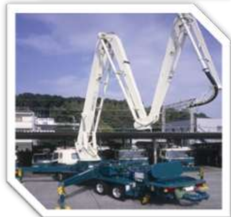
【コンクリートポンプ車】
