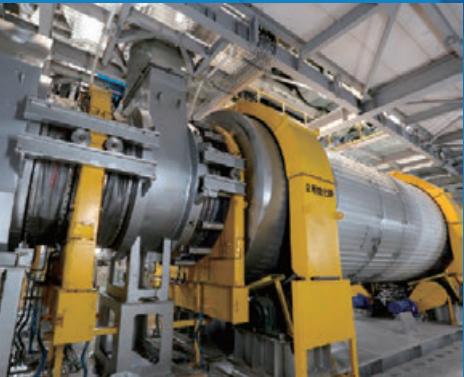
長崎県西海市のごみ炭化燃料製造施設で稼働中の川崎重工製炭化炉(資料提供: 川崎重工業株式会社)
