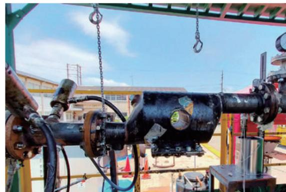
機械式フォームドアスファルト発生装置製品化完了
