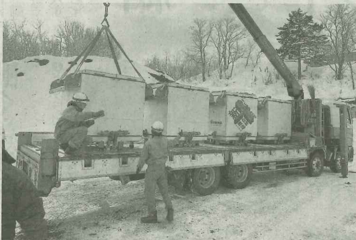
北海道で行われたアスファルトの合材新運搬システム「オカモチ」のテスト。日工提供
