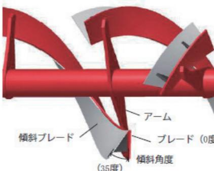
図一1 ブレード傾斜角度
