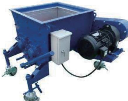
写真一2 本試験で用いたテストミキサ
