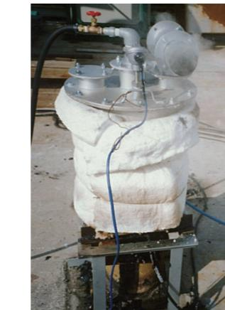
写真-2 VOC(臭気成分)発生装置
