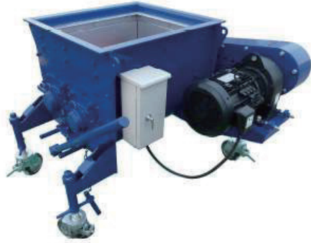
写真—2 本試験で用いたテストミキサ
