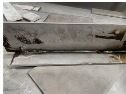
写真6 設置後ステンレス材による テスト溶接 板厚2ミリ
