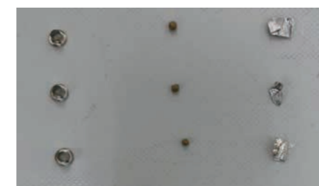
図5-2 異物(左から金属片,粒状土,アルミ片)
