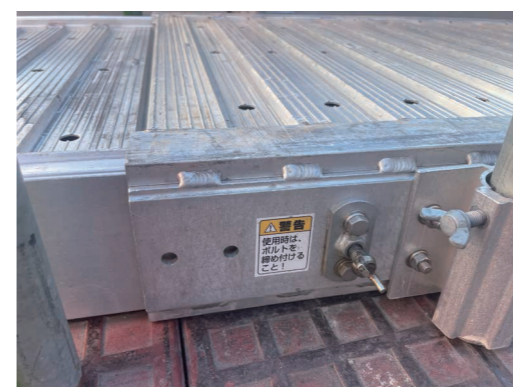
▲寸法固定用の蝶ボルト。外床側から締め、内床を押さえつけることで固定。
