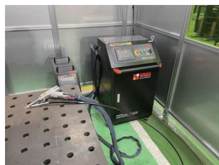
写真5 設置状況 定盤の上へ溶接トーチ
