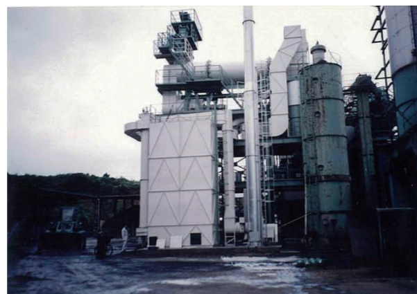
写真-2 リサイクルドライヤ専用のミストフィルタ(集塵機)
