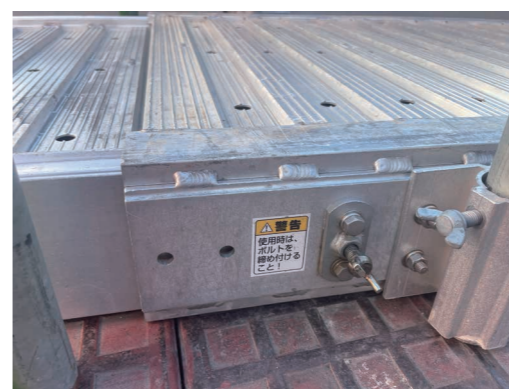
▲寸法固定用の蝶ボルト。外床側から締め、内床を押さえつけることで固定。
