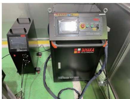
写真4 設置状況 本体 左側:ワイヤ送給 右側:ファイバー溶接機本体
