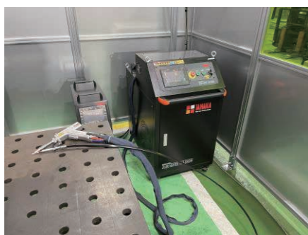
写真5 設置状況 定盤の上へ溶接トーチ
