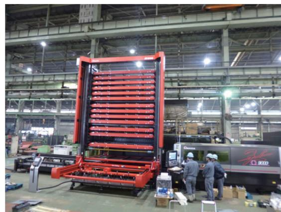
写真5 アマダ製ファイバーレーザー切断加工機
