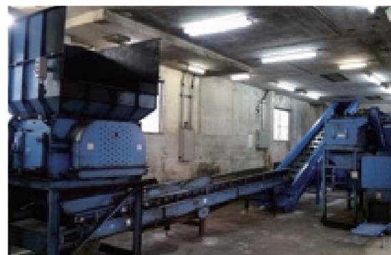
資料J 「破袋機、破袋補助コンベヤ、傾斜コンベヤ」
