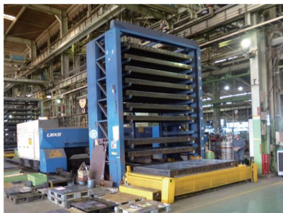
写真1 レーザ2号機 (3kW CO2レーザー)
