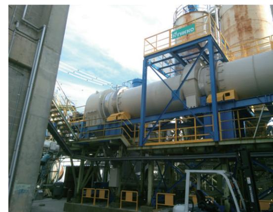
写真-8 II型無水石膏製造装置のロータリーキルン
