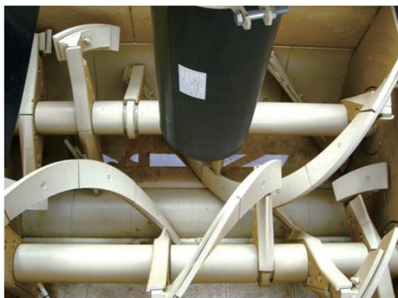
写真-9 新タイプ実機ミキサ(練混ぜ容量1.67m<sup>3</sup>)
