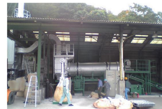
写真-2 定置式半水石膏製造システムNPR-400の全景
