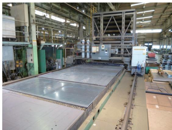
写真2 レーザ4号機 (4kW CO2レーザー)
