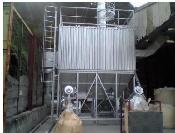
写真-6 定置式のバグフィルタ<sup>2)</sup>
