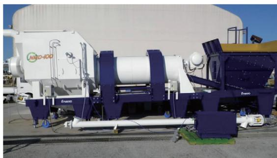
写真-1 移動式半水石膏製造システムNPR-100の全景<sup>8)</sup>
