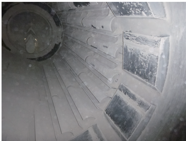
写真-9 ロータリーキルンの内部(乾燥加熱領域)
