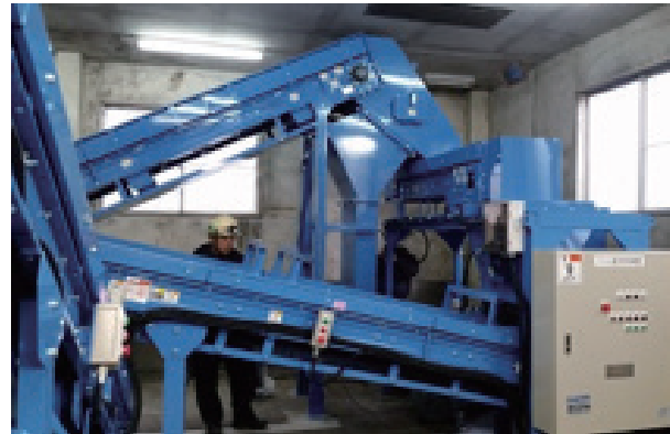
資料I「傾斜コンベヤ、PETRIS、手選別コンベヤ」
