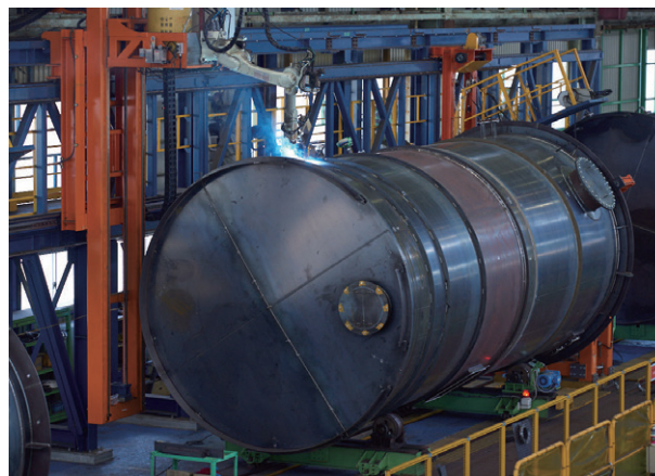
写真2 タンクの無人自動溶接
