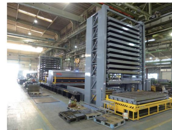
写真4 ファイバーレーザー切断加工機
