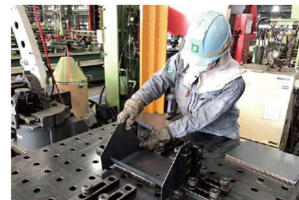
写真5 ステップ3 反対側の側板の設置
