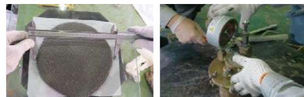
写真-2 実験風景 左:ミニフロー測定 右:空気量測定
