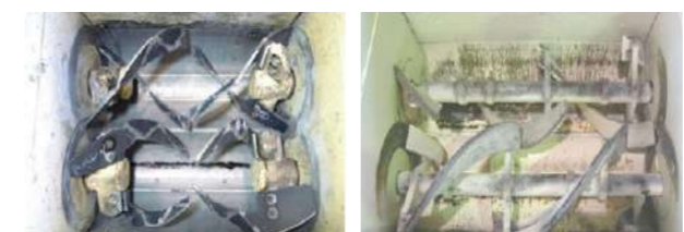
写真-3 使用ミキサ 左:新タイプ 右:汎用タイプ
