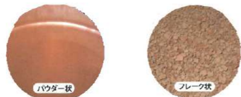
図19 一般的なレーザ集塵ダスト 図20 F1の集塵ダスト
