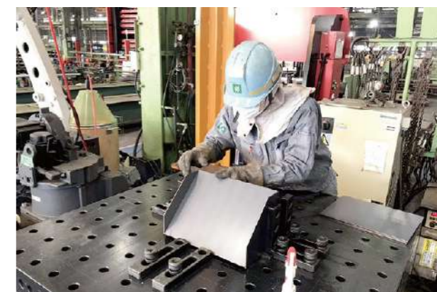
写真6 ステップ4 上板の設置
