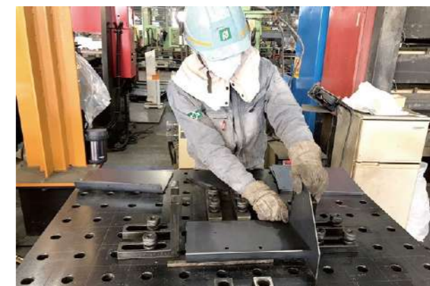
写真4 ステップ2 側板の設置
