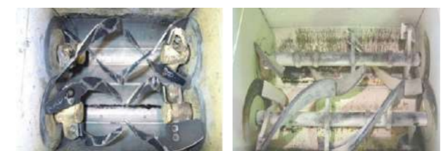
写真-3 使用ミキサ 左:新タイプ 右:汎用タイプ
