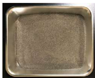
写真3 破砕後の再生骨材
