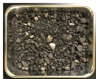
写真2 破砕前の再生骨材
