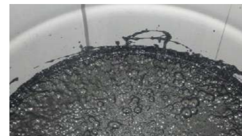
写真9 フォームドアスファルト
