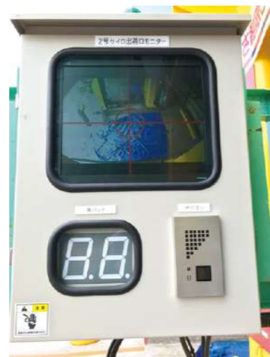
写真7 出荷口積込支援装置(みえ〜る君)
