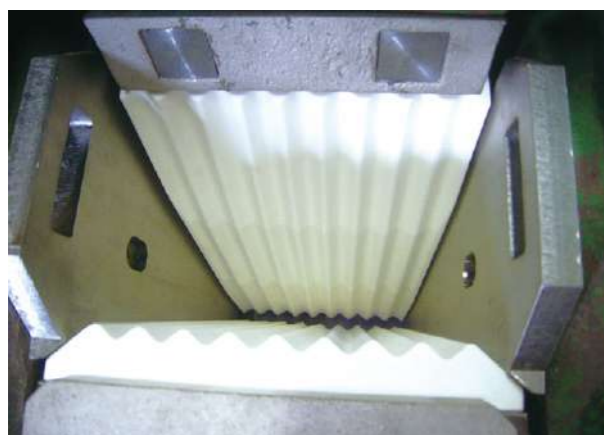
図13 セラミックス製歯板
