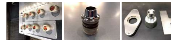
図6 ノズルチェンジャー 図7 ノズル本体 図8 ノズル交換セット
