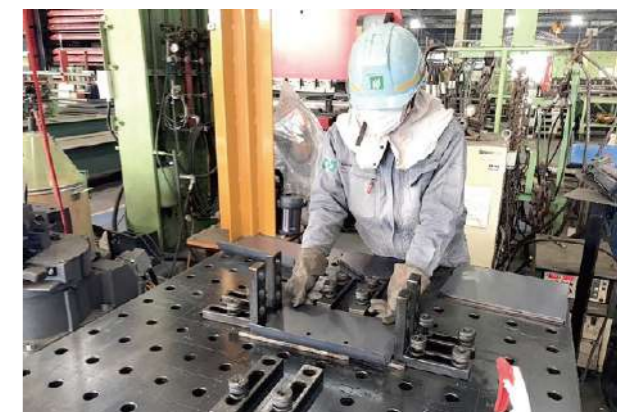
写真3 ステップ1 底板の設置
