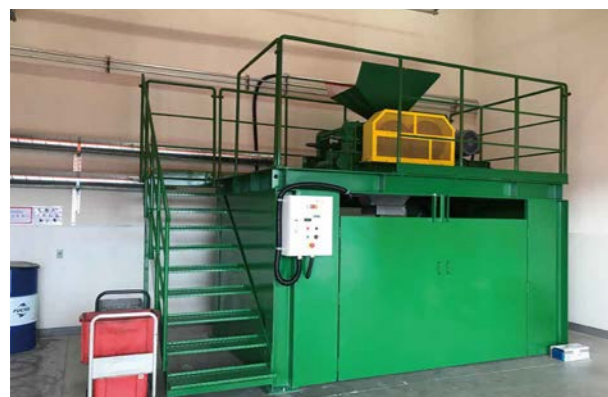
図13 ガラス小瓶破碎 RBT-1610G型
