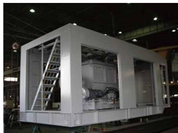
(フリーモードミキサが搭載されたミキサユニット)
