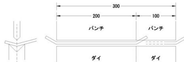
資料4 加工時の金型配置
