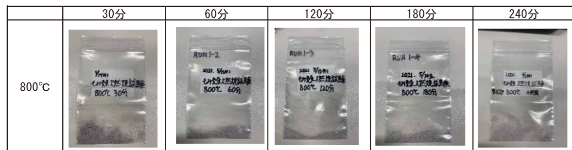
図3-1. もみ殻加熱試験結果(800℃)
