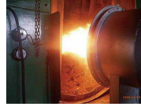
写真-17 木質タールの燃焼実験
