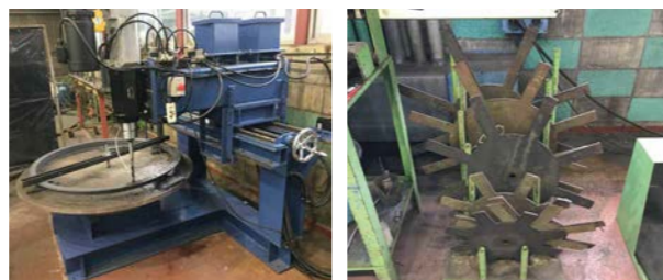
図2 フランジワーク設置 図3 フランジ設置治具
