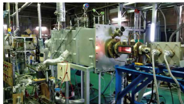
図2 試験用10kWクラスアンモニアバーナ
