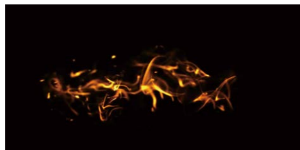
図3 高速カメラによる火炎写真 (15kWアンモニア混焼率30%空気比1.2)
