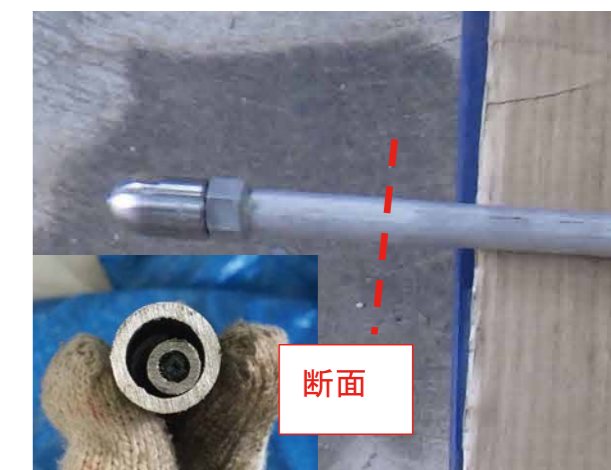
写真2-4. 加熱軽質タールノズル(従来品)
