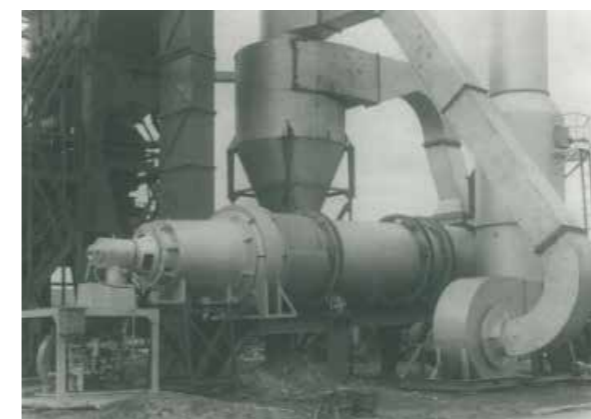
写真-5 旧型APの骨材乾燥システム
