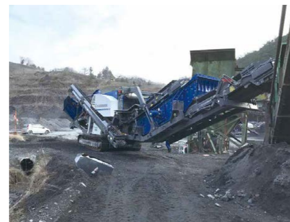
写真2 茨城県現場 材料:硬質砂岩 80-40→20-0
