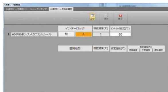
図5-6 AS配管ヒータ機能選択画面
