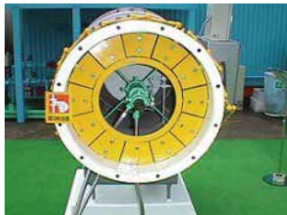
写真-10 WELLバーナに搭載したフロントマルチベーンダンパ
