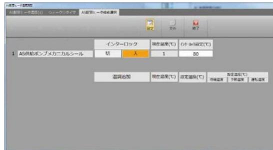
図5-6 AS配管ヒータ機能選択画面
