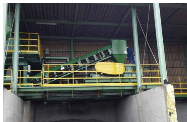
図11 アスガラ破碎 RBT-2416G型
