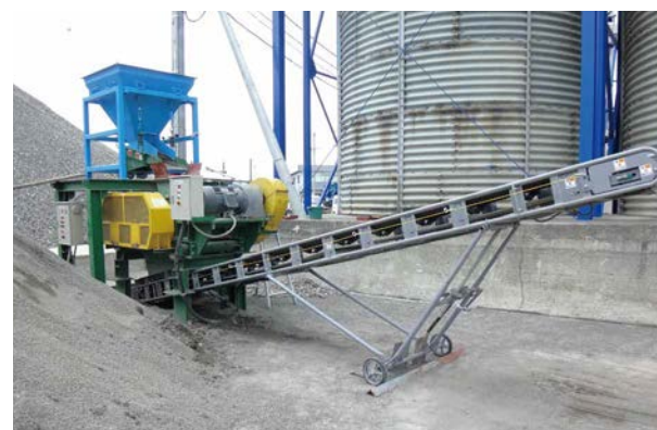
図14 ビリ破碎 RBT-2416G型
