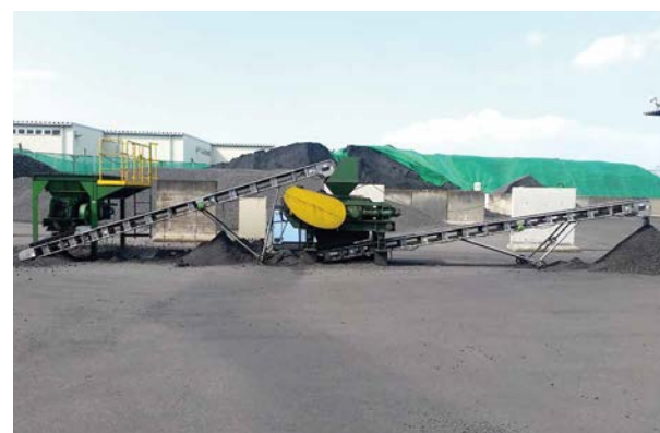
図16 コークス破碎 RBT-2416G型
