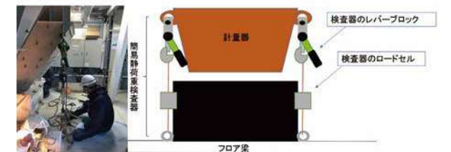
図7 簡易静荷重検査説明図
