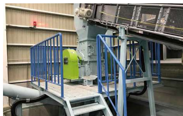
図13 ALC破碎 HCB-2418T型
