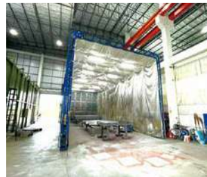
(写真7) 塗装ブース
