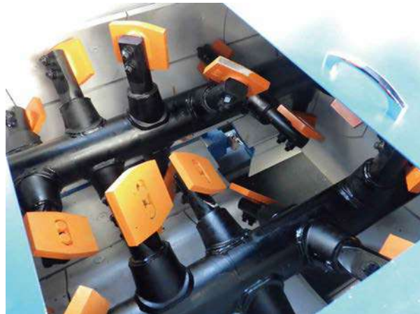
ミキサ内部(羽根(オレンジ)取付軸の補強)
