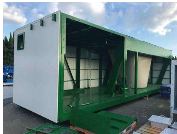
写真3 仮組前の初号機ユニットの一部
