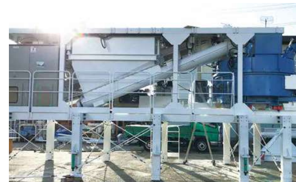
写真3: セメント計量装置: 排出スクリー一体型
