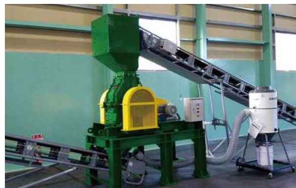
図11 電気部品破碎 HCB-1810TR型
