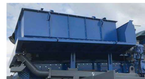
固化材貯蔵装置の上半分を原料土投入口内に収納
