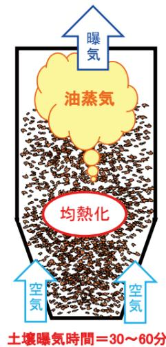
図-7 ストックビン内部のイメージ<sup>12)</sup>
