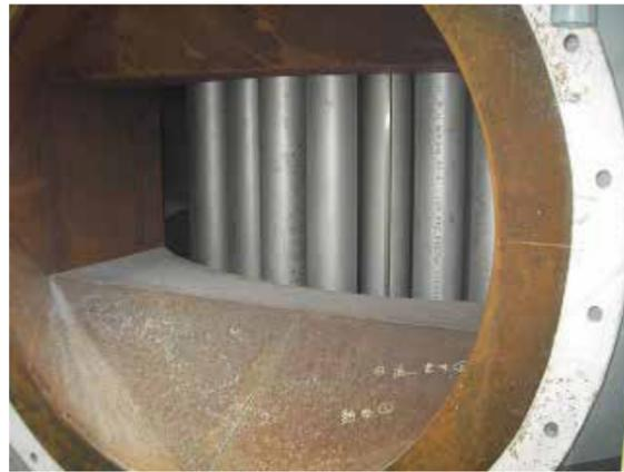
写真-16 NTR-StageVIの熱交換器側面の受熱ガス導入口
