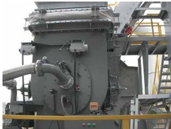
写真-17 NTR-StageVIの一次処理装置用の予熱空気バーナ
