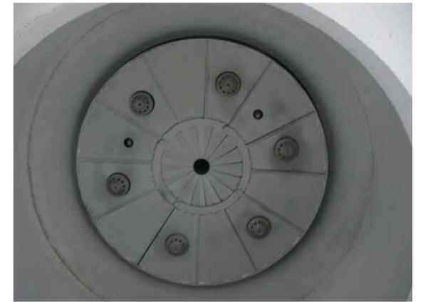
写真-18 NTR-StageVIの一次処理装置用バーナの内部
