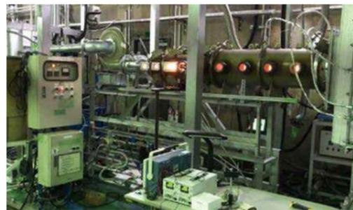
図5 100kW燃焼試験の様子
