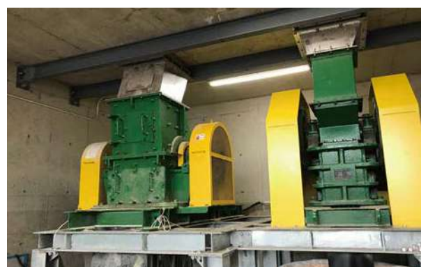
図12 セラミック品破碎 HCB-2418T型(左)
