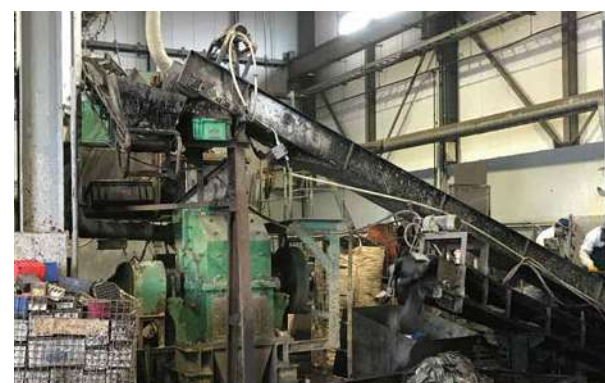
図16 バッテリー破碎 HCB-3624型
