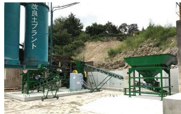
図15 がれき類破碎 HCB-2418T型
