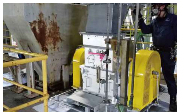
図14 焼却灰破碎 HCB-2418T(水冷)型
