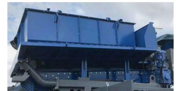
固化材貯蔵装置の上半分を原料土投入口内に収納
