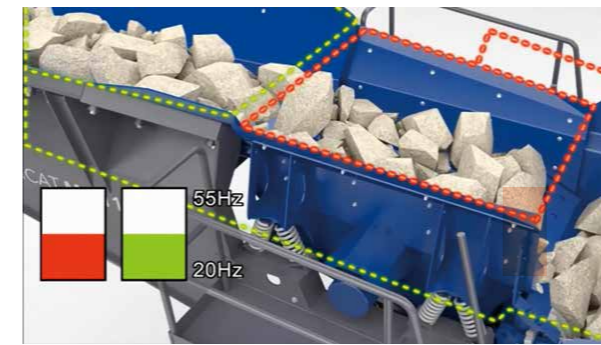
図3 CFSシステム(連続供給システム)
