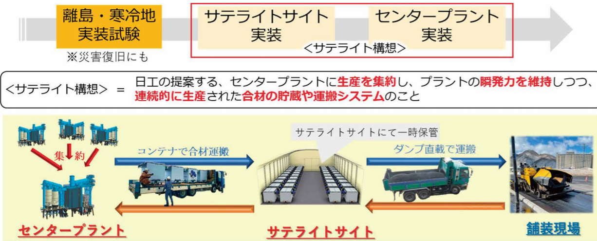
図-15 合材の貯蔵や運搬システムの構築
