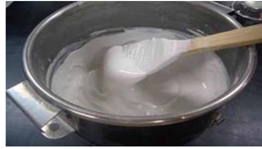
写真-1 本節の実験で用いたW/S=140%のMCクレ- 8)
