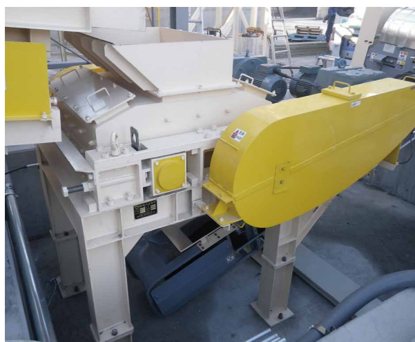
図14 コンクリートブロック破碎 MRL-900型
