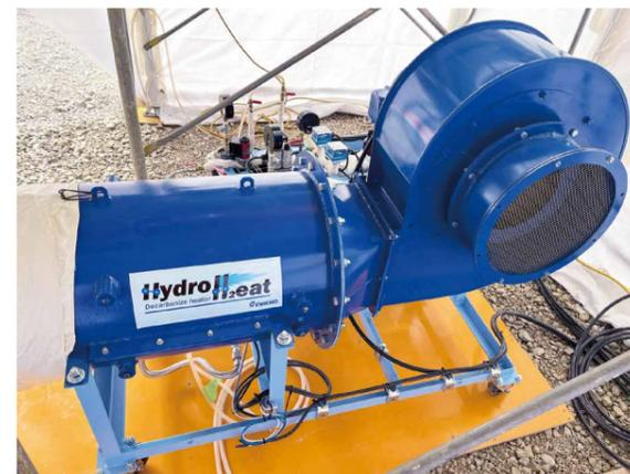
写真-1 ハイドロヒート試験機
